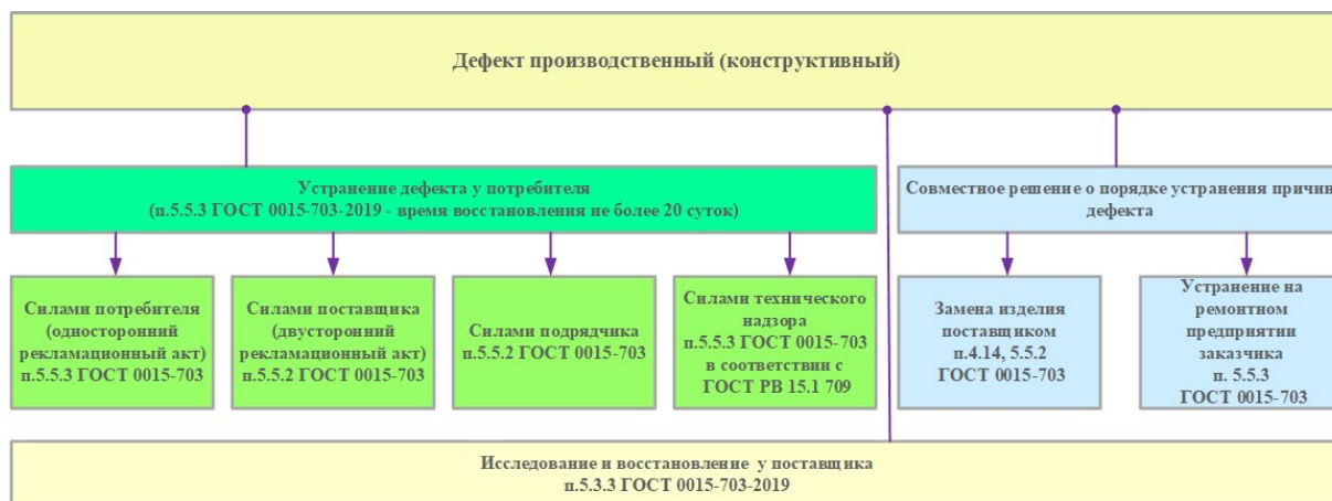
Рис. 5. Варианты устранения производственного дефекта
