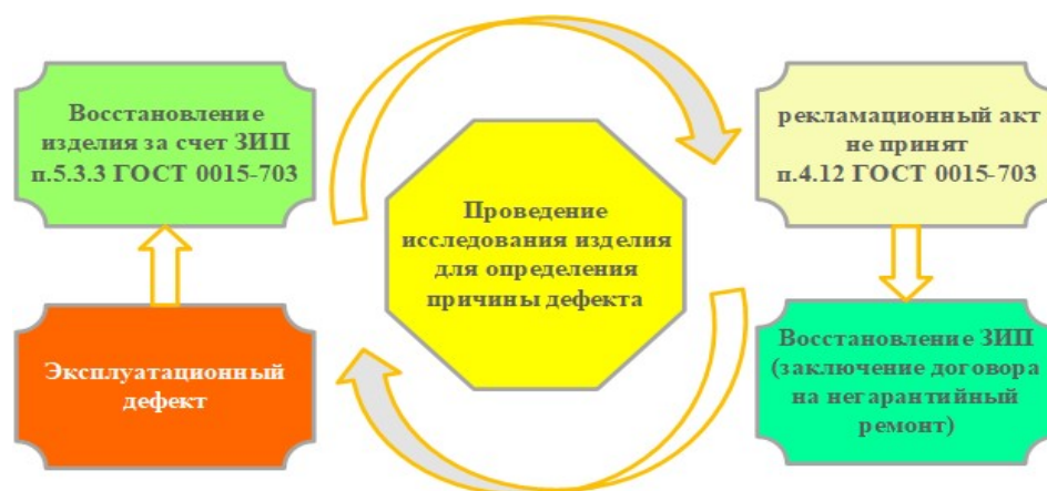
Рис. 4. Порядок восстановления изделия при эксплуатационном дефекте
