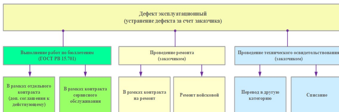
Рис. 3. Варианты устранения эксплуатационного дефекта
