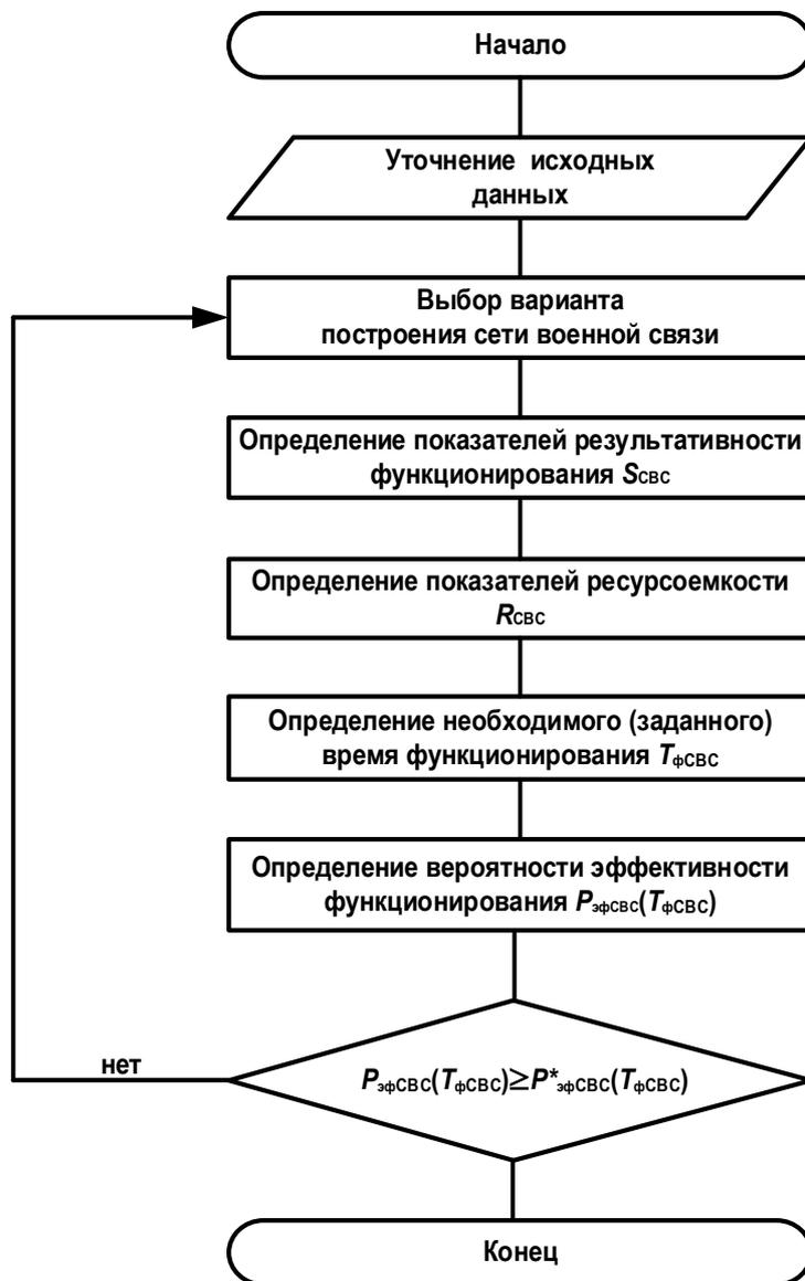
Рис. 2. Общая последовательность оценки вариантов построения сети военной связи по критерию эффективности ее функционирования
