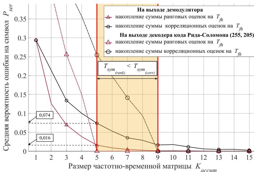
Рис. 7. Зависимость средней вероятности ошибки на символ для некогерентного и непараметрического рангового демодуляторов сигналов МПЧТ от размера частотно-временной матрицы сигнала  $K_{accum}$  в канале с интерференционными замираниями, аддитивной гауссовой помехой  $h_0^2 = 8$  дБВт и импульсной помехой
