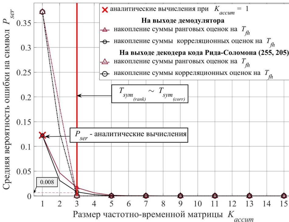
Рис. 6. Зависимость средней вероятности ошибки на символ для некогерентного и непараметрического рангового демодуляторов сигналов МПЧТ в зависимости от размера частотно-временной матрицы сигнала  $K_{accum}$  в канале с интерференционными замираниями и аддитивной гауссовой помехой  $h_0^2 = 8$  дБВт
