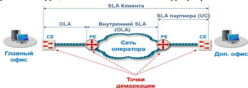
Рис. 7. Варианты точек демаркации [23]
