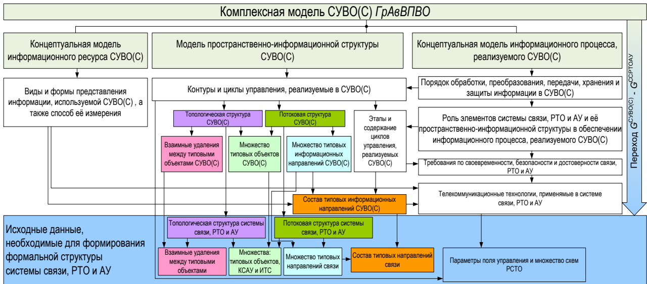
Рис. 1. Переход от комплексной модели СУВО(С) ГрАвВПВО к пространственно-информационной структуре обеспечивающей СС, РТО и АУ
