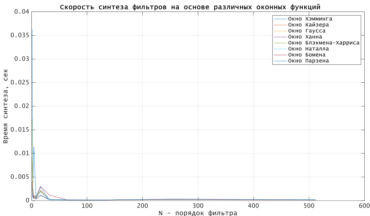
Рис. 2. Скорость синтеза цифровых фильтров порядков: 1, 2, 4, 8, 16, 32, 64, 128, 256, 512 с помощью оконных функций
